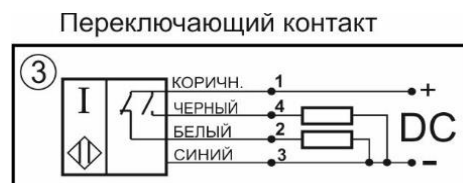
Цоколевка клеммной колодки
