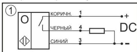
Схема соединения Нормально-разомкнутый контакт
